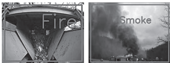
図-3 ディープラーニングを用いた火花・煙の検知
