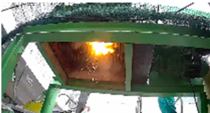
(左) リチウムイオン電池破碎時の瞬間 (右) システムによる火花検知の様子
